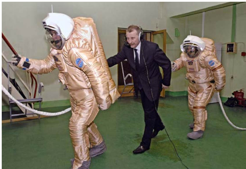
Испытание скафандров для имитации выхода космонавта на марсианскую поверхность. Фото: ИТАР-ТАСС
